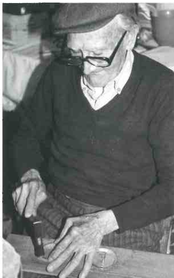
A lato: Carmelo Starrantino (a. 80), costruttore-suonatore, impegnato nella realizzazione di un tamburello (taglio della pelle, ribattuta dell'orlo dei piattini). Sciglio (fraz. di Roccalumera), 1991.
